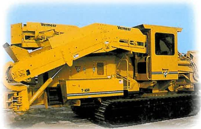
*La T-658 è dotata di convogliatori pieghevoli per facilitare il trasporto da un cantiere all'altro, con minimi interventi manuali. Il convogliatore di carico della T-658 solleva il materiale di scavo e ruota di 110° per permettere di caricarlo su di un camion, migliorando la produttività.*
